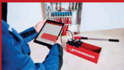
Digitale druksensor maakt nauwkeurige instelling van de testdruk mogelijk
